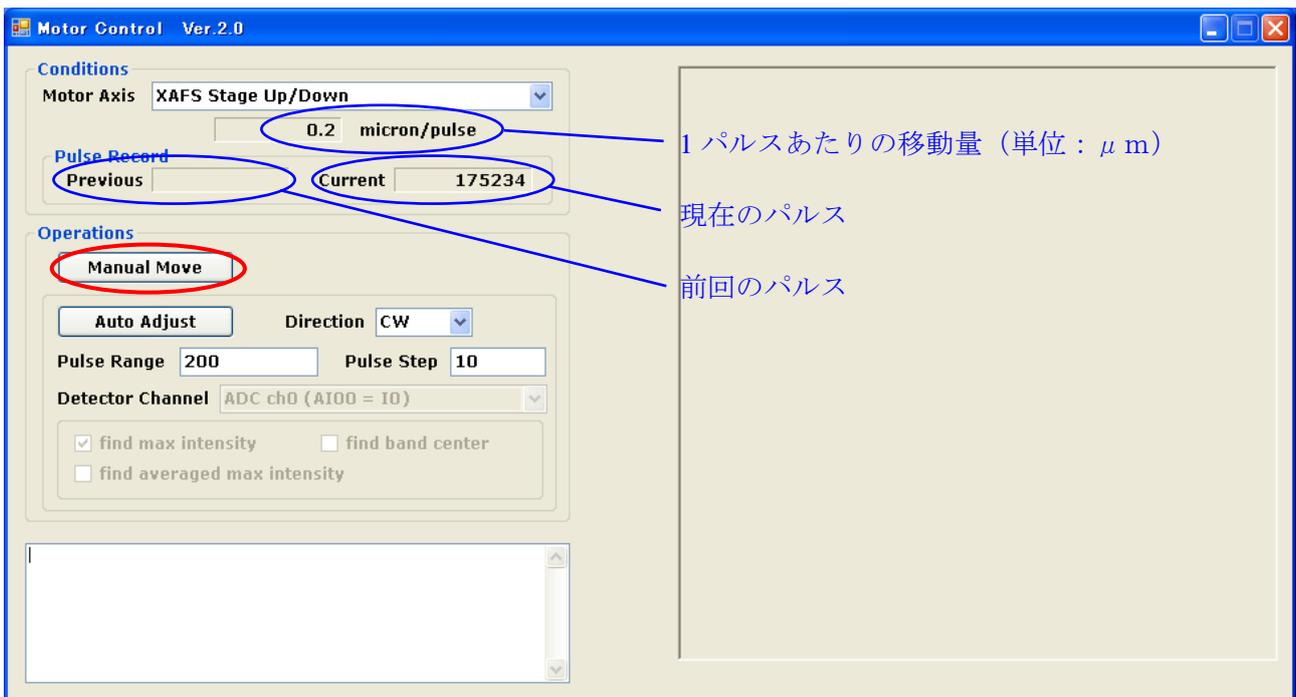
「Manual Move」画面が表示されるので、動かすパルスの相対量、スピードを設定し、「CCW」もしくは「CW」をクリックしステージを動かす。（下図は「XAFS Stage Up/Down」を選択した場合）
