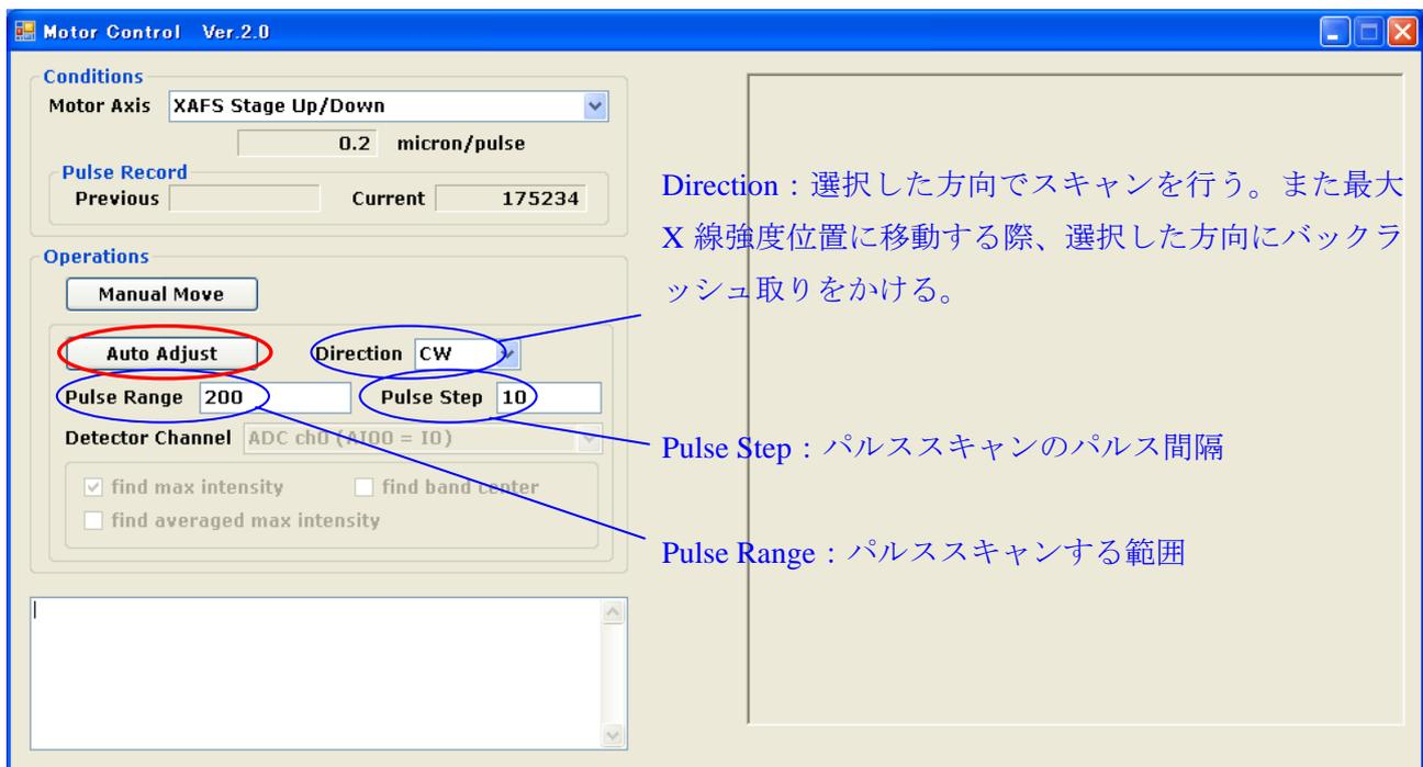
「Direction」でCW or CCWを選択、「Pulse Range」「Pulse Step」を入力し「Auto Adjust」をクリック。パルススキャンが開始し「Motor Control」画面右に強度分布が表示され、スキャン終了後、X線強度最大の位置にパルスが移動し停止する。
