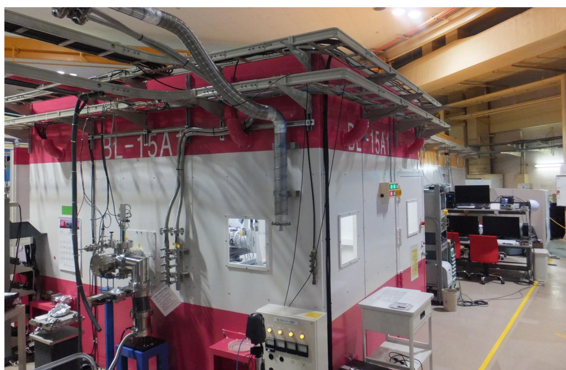
図. ハッチ外観 3.2 m(長さ) x 4.0 m(幅)、BL16側に大扉(2.4H x 2.1W m)を備える
